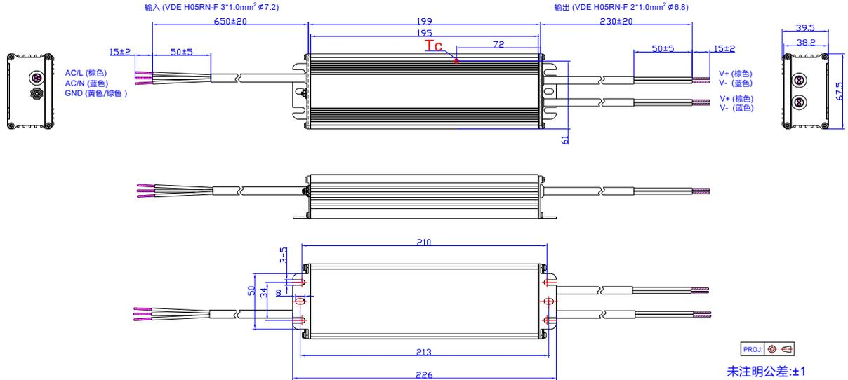
注：2 条输出线在内部为并联连接。单根 1.0mm<sup>2</sup> 最大允许通过电流为 10A。使用过程请将 2 根棕色线连接在一起，同时，2 根蓝色线连接在一起，确保平均分担电流。
